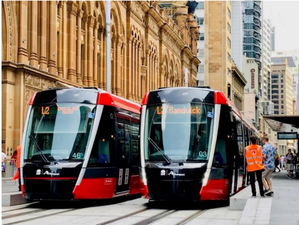
Şekil 34. Sidney Tramvayı Katenersiz(APS) Kısım (Alstom, 2020)
