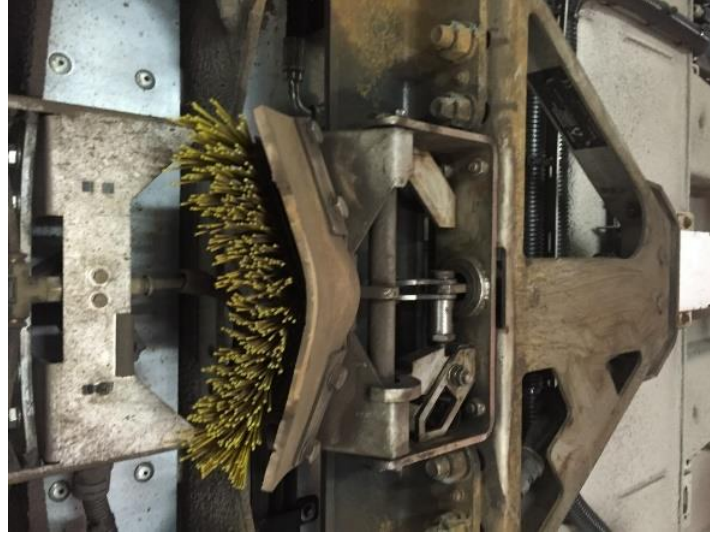
Şekil 19. APS Rayı Temizleme Fırçası (Metro İstanbul, 2020)
